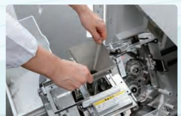
薬剤を分包紙に投入するSHホッパーも設計を一新。薬剤が付着しにくい、つぎ目がない構造としました。簡単な操作で取り外しができるため、クリーナーによる清掃はもちろん、布を使った乾拭き・水拭きも可能です。
