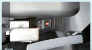
※写真は散剤検知センサー。
